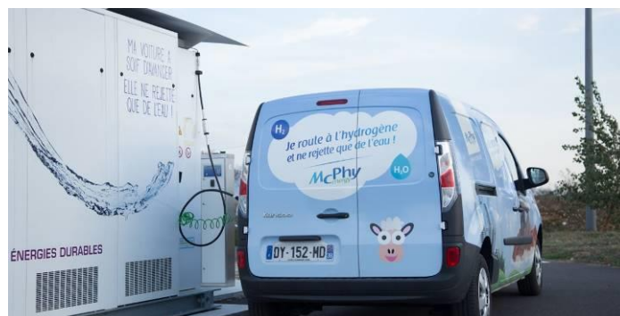
Tüzelőanyag-cella range extender-rel rendelkező Renault Kangoo ZE H2 tankolása hidrogénnel.
